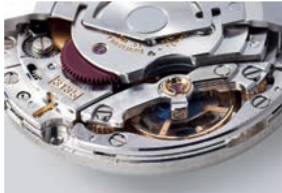
Abb. 13 Marktführer Rolex mit seinem exzellenten Automatik-Kaliber 3135. Die mit gebläuter Breguet-Spirale arbeitende Unruh wird in einer in der Höhe einstellbaren Brücke gelagert. Am Unruhreif ganz vorne ist noch die rändelförmige Feinstellung »Microstella« zu sehen.
