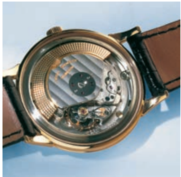
Abb. 33 Kaliber K 2070 mit 29 Steinen. Der Rotor wird mit vier Rubinwalzen geführt, die Rotorträgerplatte ist mit Genfer Streifenschliff verziert. Im Vordergrund die Reglage mit Schraubenunruh, Mikrometerschraube und Schwannenhalsfeder.
