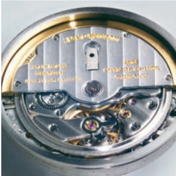
Abb. 37 Kaliber K 2121. Berylliumring, Rotorträger und Schwunggewicht sind gemeinsam vierfach verschraubt. Der Berylliumring läuft auf vier vertikal gelagerten Rubinrollen. Der Rotor wird zentrisch von der Innenbohrung des mit dem Rotor vernieteten Triebes geführt, dessen Achse aus einem gut dimensionierten Beryllium-Hohlflansch besteht. Im Vordergrund die dreischenklige Unruh mit verstellbarem Spiralklotzenträger und Rücker ohne Feinstellung.
