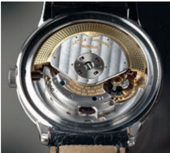
Abb. 34 Kaliber K 2071, auf der Automatikbrücke steht die Gravur »TWENTY NINE (29) JEWELS, ADJUSTED TO HEAT COLD ISOCHRONISM AND FIVE (5) POS.«.
