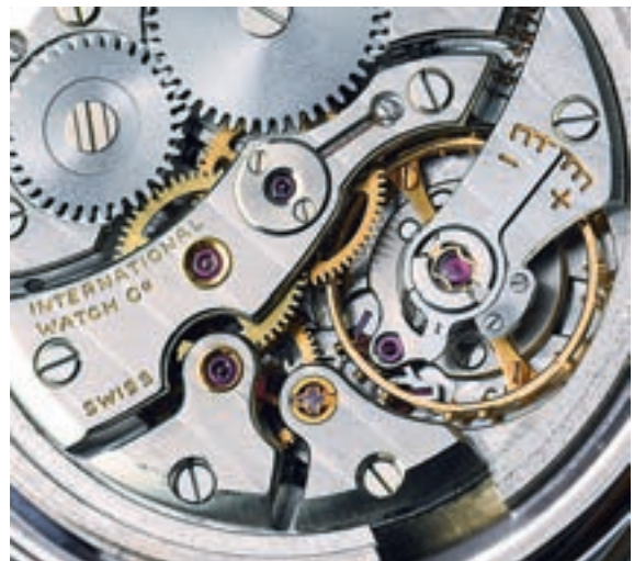
Abb. 14 Ausschnitt eines IWC Handaufzugwerks Kaliber C. 89 in bisher nicht bekannter Sonderausführung, verbaut in einem Modell Yacht Club. Dieses Werk entpuppte sich wegen seines besonders hohen technischen Niveaus als Sensation. Einzelheiten hierzu sind im Kapitel 5. IWC nachzulesen (Werk-Nr. 1.955.875).
