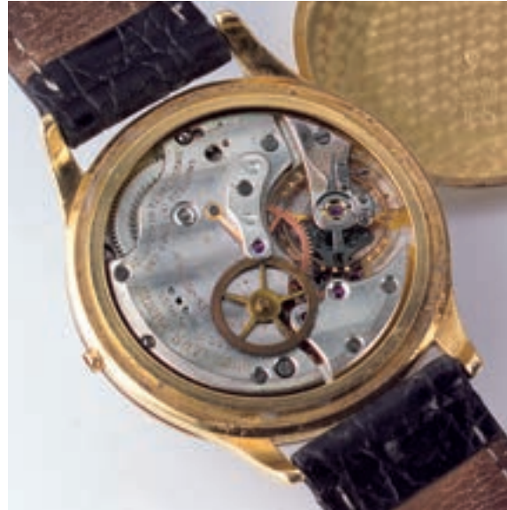
Abb. 29 Valjoux-Kaliber 13 mm VZSSC, wobei »SC« für Zentralsekunde steht. Im Vergleich zur links abgebildeten Variante der fast identischen Kaliber kann man hier Sekundenrad und Brücke für die Zentralsekunde erkennen. Aufgrund dieser zusätzlichen Komponenten ist die Werkhöhe auf 5,00 mm gestiegen.
