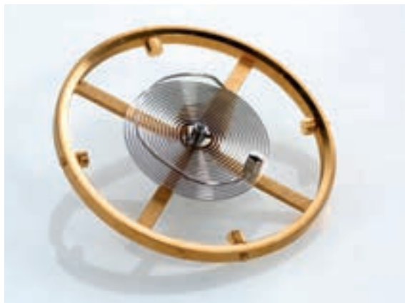
Abb. 10 Unruh mit Breguet-Spirale und Microstella -Feinstellung des Kalibers 3135 von Rolex
