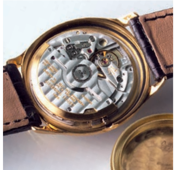
Abb. 38 Kaliber 2123 mit 26,00 mm Einbaudurchmesser, 3,25 mm Bauhöhe, 33 Lagersteinen und 21.600 Halbschwingungen/h, Rohwerk von Jaeger-LeCoultre auf der Basis des Kalibers 889.
