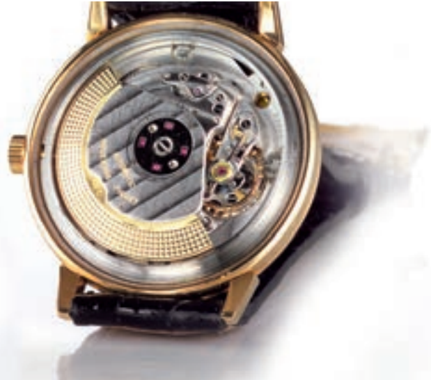
Abb. 35 Kaliber K 2072 mit Schraubenruh und Feinstellung über Mikrometerschraube und Schwanenhalsfeder. Mit der Integration der Datumsanzeige stieg die Bauhöhe des Werkes von 5,50 auf 6,30 mm.
