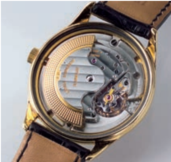
Abb. 31 Kaliber P 2498/2 (2 steht für Rotorkugeln aus Rubin) mit kleiner Sekunde bei 6 wurde als reserviertes Rohwerk (Ebauche) von Jaeger-LeCoultre aus dem nur drei Kilometer entfernten Le Sentier geliefert. Der Rotor verfügt über ein Schwinggewicht aus 18 K Gelbgold und zieht in beiden Drehrichtungen auf. Die Schraubenunruh besitzt bereits eine Stoßsicherung, der Rücker wird über Mikrometerschraube mit Schwannenhalsfeder eingestellt.
