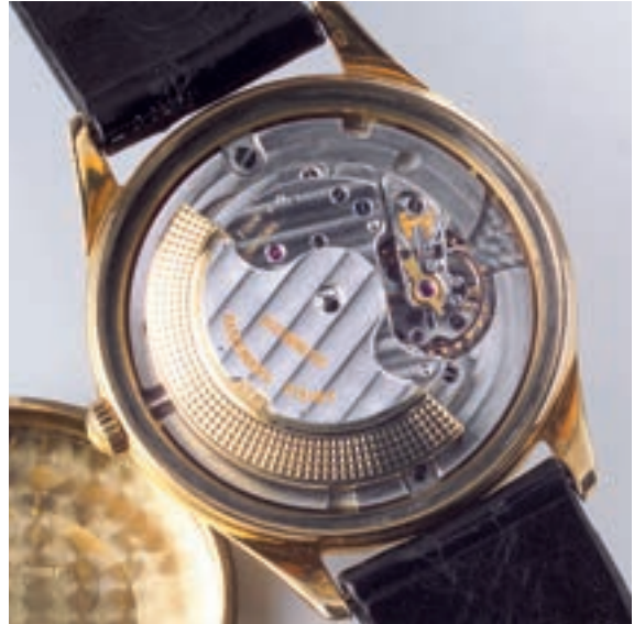
Abb. 32 Kaliber P 2499/1; der Rotorträger war bei diesem AP-Kaliber immer mit Genfer Streifenschliff verziert. Die Kaliber P 2498 und P 2499 sind in vier Positionen und Temperaturen reguliert und arbeiten mit 18.000 Halbschwingungen/h. Beide Versionen verfügen über 21 Steine.
