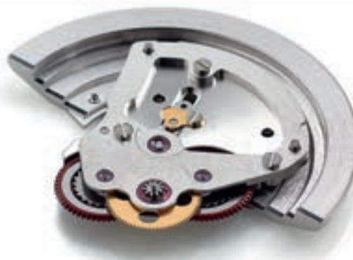
Abb. 11 Ein höchst seltenes Bild: Die ausgebaute Automatikbrücke mit Rotor des Rolex-Kalibers 3135, auf den Kopf gestellt. Deutlich erkennt man die rot- und goldfarben-eloxierten Zahnräder.
